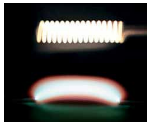
Нить галогенной лампы в сравнении с дугой лампы XENARC®
